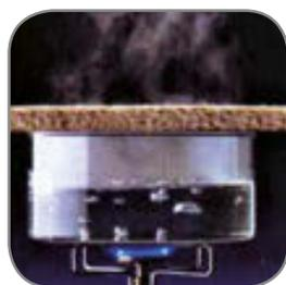
La diffusion est la migration de minuscules particules isolées (molécules d'eau) provoquée par l'agitation thermique des molécules (mouvement Brownien).
