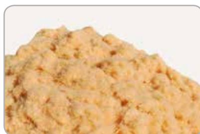
**GUTEX Thermofibre®** est composée de fibres de bois de sapin et d'épicéa non traitées provenant de la Forêt Noire en Allemagne. Grâce à sa bonne valeur lambda, on obtient une très bonne protection contre les déperditions thermiques.
