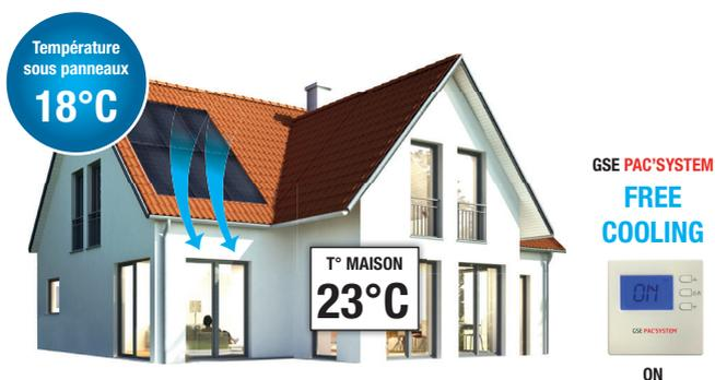
Les nuits d'été, la température sous vos panneaux est généralement inférieure à la température de votre maison d'environ **3 ou 4°C**. Le **GSE PAC'SYSTEM** récupère cet air frais dès **18°C** sous vos panneaux pour l'insuffler via vos bouches de soufflage.
