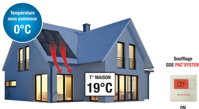
Lorsque le **GSE PAC'SYSTEM** détecte que vous avez réglé l'unité d'ambiance en mode **chauffage** à 22°C, et qu'il mesure qu'il ne fait que 19°C chez vous, alors il va automatiquement envoyer l'air chaud disponible sous les panneaux vers votre intérieur via les bouches d'insufflation.
