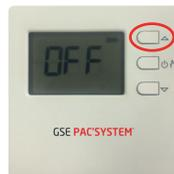
Lorsque vous passez en mode **chauffage**, une flamme apparaît en bas à droite de l'écran. Lorsque vous passez en mode **rafraîchissement**, un flocon apparaît en bas à droite de l'écran ❄️.
